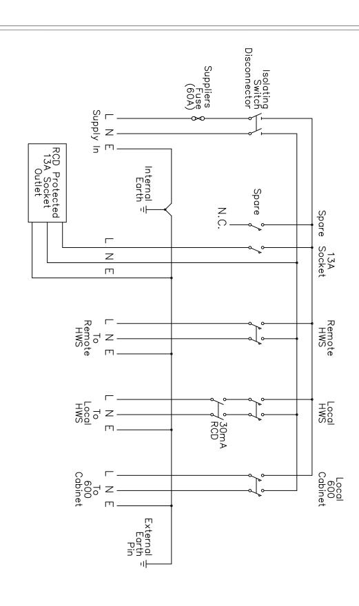
FIG. 1 TYPICAL CIRCUIT FOR PILLAR AS SHOWN
